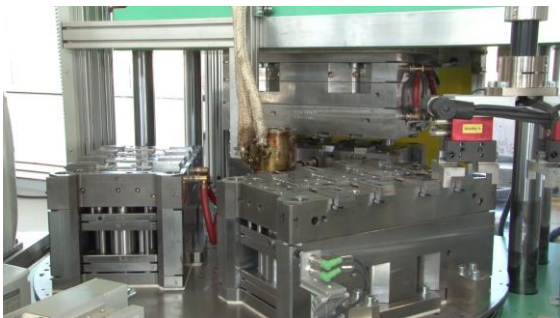
Bild 2: Ansicht des Spritzgießwerkzeugs auf dem Drehteller der Spritzgießmaschine. Quelle: IFK Automation, Balingen
