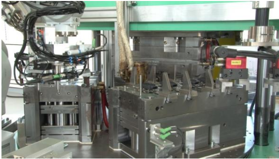
Bild 3: Spritzgießwerkzeug auf dem Drehteller während der Bestückung/Entnahme. Quelle: IFK Automation, Balingen
